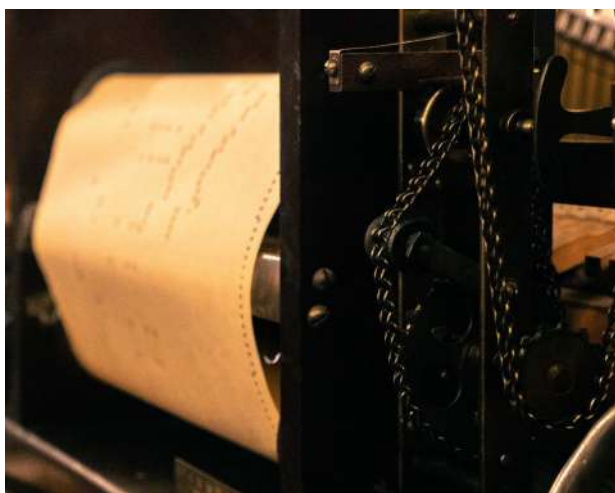
Detalle del mecanismo de la pianola, con el rollo de papel perforado desplegado. Cada perforación corresponde a una nota, que es efectivamente tocada en el instrumento.
